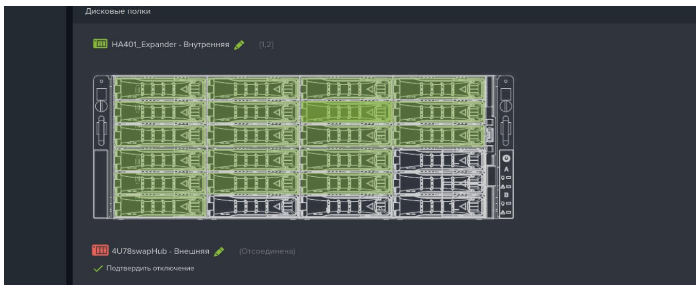
Рисунок 46. Изображение отключенной дисковой полки в меню мониторинга аппаратного обеспечения
