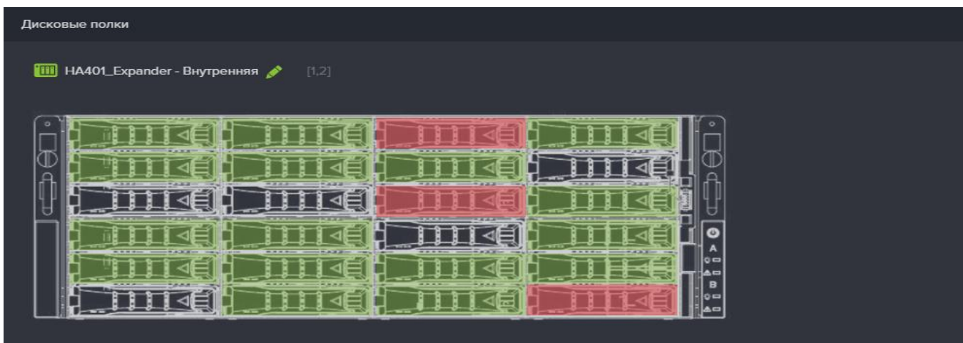
Рисунок 43. Отображение удаленных или неисправных дисков в меню аппаратного мониторинга
